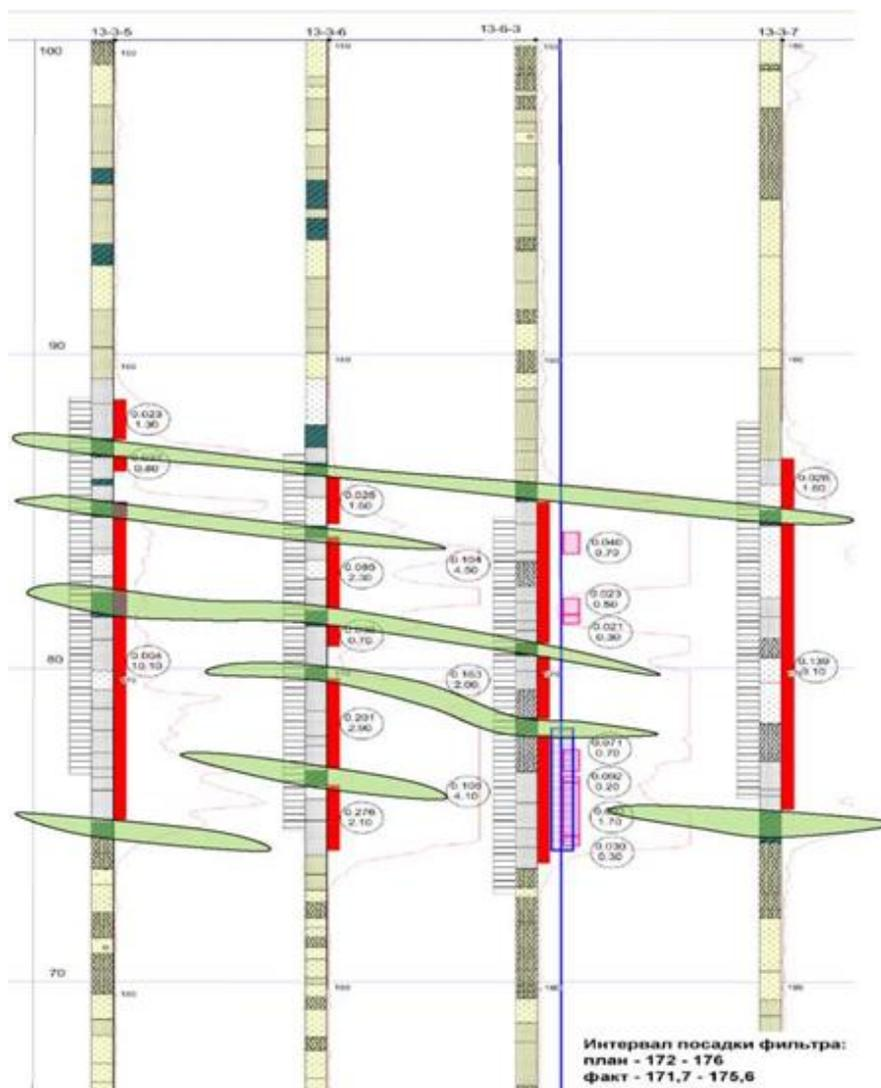
Рисунок 17 - Разрез по профилю 19 через технологические и эксразведочную скв. 1001
